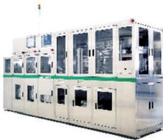
切断成形検査一貫装置
